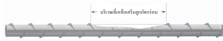
รูปที่ 18 บริเวณเหล็กเสริมที่มีการกัดกร่อนเป็นสนิม (ที่มา: ICRI 03730) (ข้อ 5.4.5)
